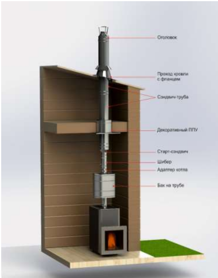
Рис.10 Способ монтажа дымохода на банную печь с баком на трубе.
